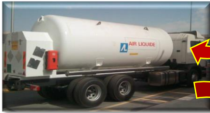
LNG delivery truck
